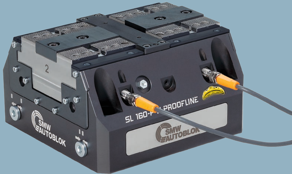
3 Die kompakten, zentrisch spannenden Kraftspanner »SL Proofline« eignen sich für die Automatisierung und für Industrie-4.0-Anwendungen. Auf engstem Raum können hohe Spannkräfte erreicht werden, die sich stufenlos regulieren lassen.
